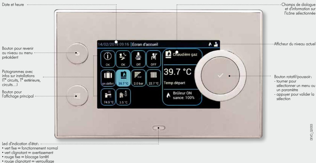
Le tableau VM DIEMATIC ÉVOLUTION intègre d'origine une régulation programmable travaillant en fonction de la température extérieure et éventuellement de la température ambiante si une commande à distance (livrable en option) est raccordée.
