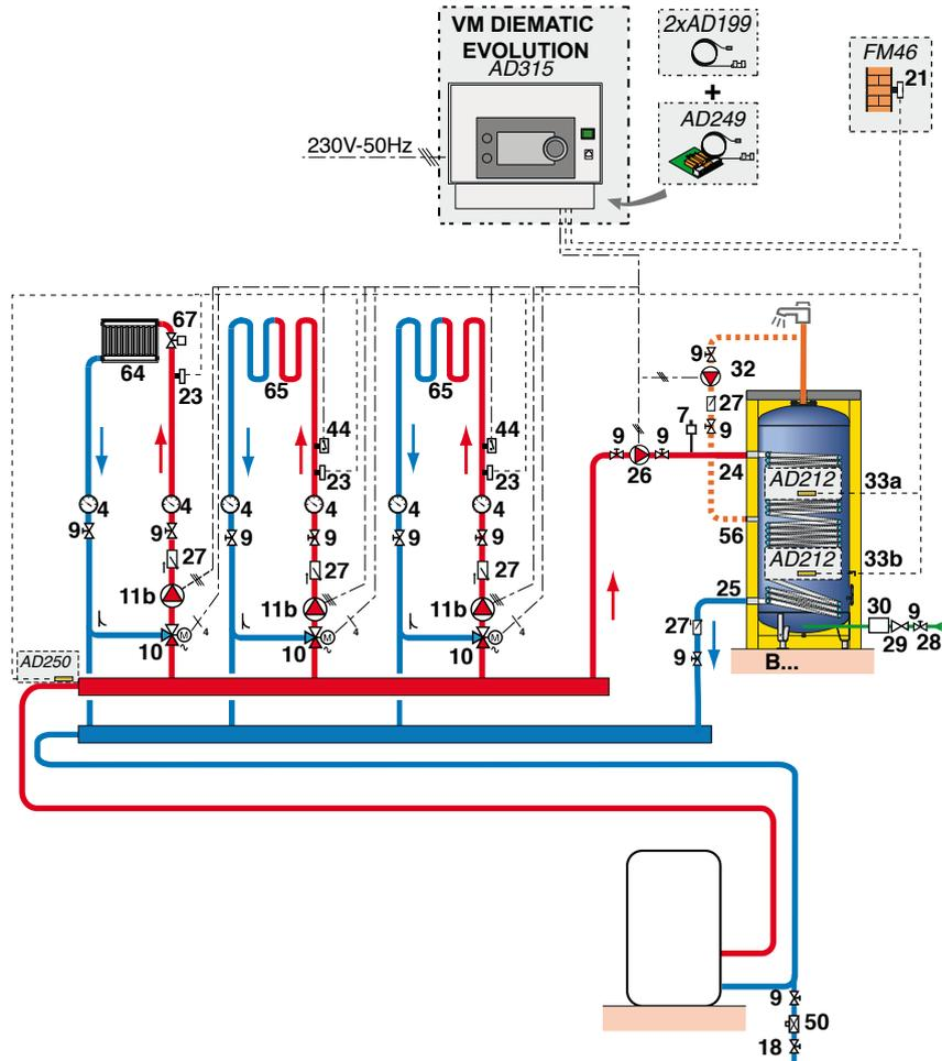
Pour cette configuration, il est nécessaire d'installer sur le boîtier VM DIEMATIC EVOLUTION les colis :
