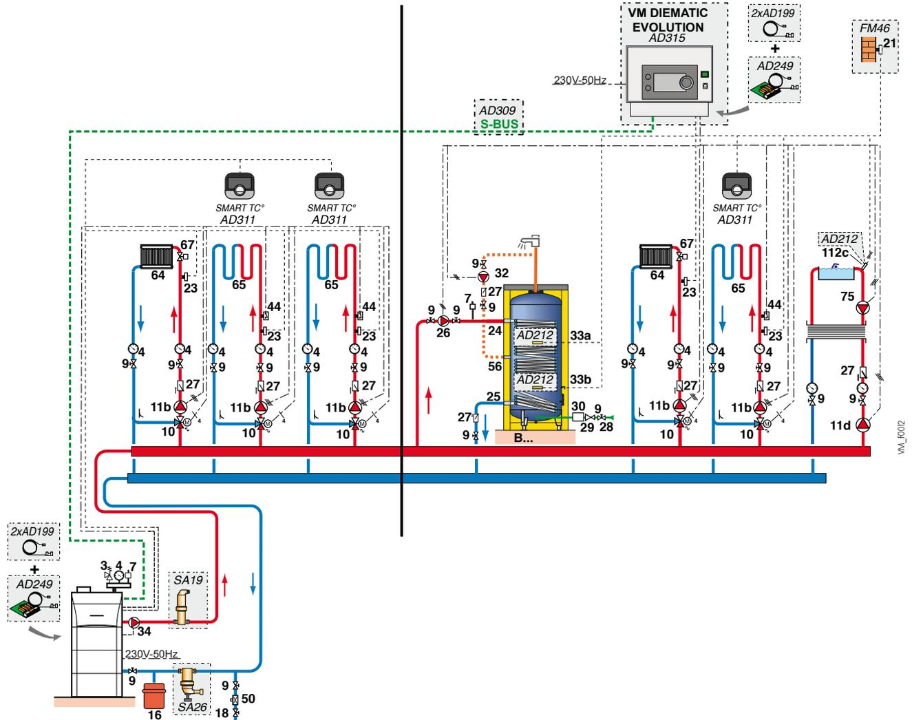
Pour cette configuration, il est nécessaire d'installer sur le boîtier VM DIEMATIC EVOLUTION les colis :
