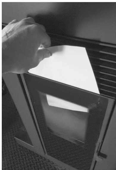
Fig.101 Vérification de l'étanchéité de la porte
