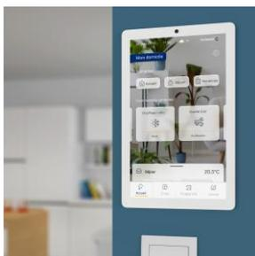
Enov@home est une solution interconnectée. Son écran tactile permet de piloter et réguler l’installation : eau chaude sanitaire, chauffage, climatisation, rafraîchissement et purification d’air. Plusieurs programmes sont disponibles pour économiser et optimiser l’énergie. La mise en place de thermostats dans chaque pièce assure la gestion individuelle et l’homogénéité du confort thermique dans toutes les pièces de l’habitation.
